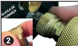
A montagem da mangueira do KMD Smart PTT contém um sistema Dri-Pak (consulte a página 9) que elimina o acúmulo de umidade e, conseqüentemente, a possibilidade de corrosão. Não importa qual "extremidade" da linha de ar do Dri-Pak™ é colocado, mas é mais prático conectá-lo mais próximo da unidade principal [Figura 3].
